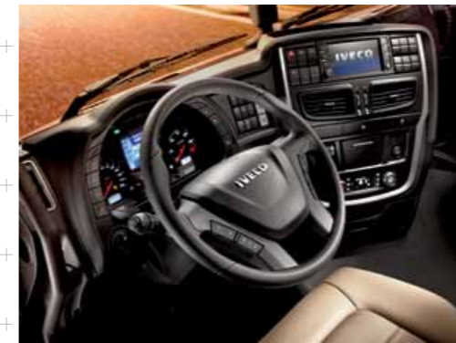
НОВОЕ РУЛЕВОЕ КОЛЕСО С ИНТЕГРИРОВАННЫМ УПРАВЛЕНИЕМ
