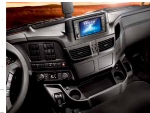
"IVECONNECT" МНОГОФУНКЦИОНАЛЬНЫЙ СЕНСОРНЫЙ ДИСПЛЕЙ
