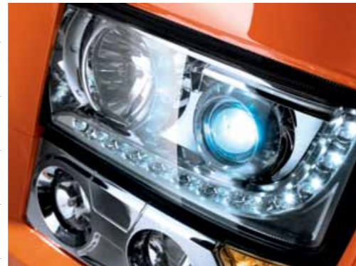
КСЕНОНОВЫЕ ФАРЫ ОСНОВНОГО СВЕТА И СВЕТОДИОДНЫЕ ДНЕВНЫЕ ХОДОВЫЕ ОГНИ
